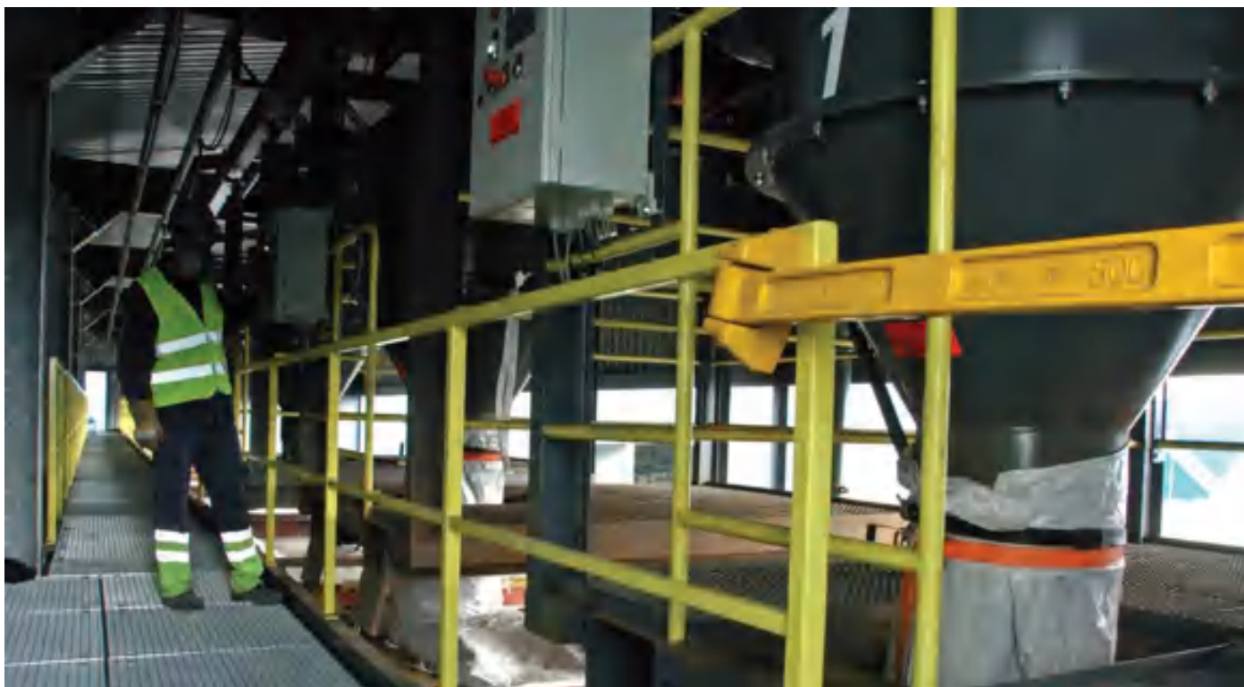
Afb. 2 De zeecontainers worden beladen met behulp van in totaal drie vulstations
